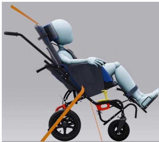
Слика 20б Правилно причвршћивање појас за кукове – поглед са стране
