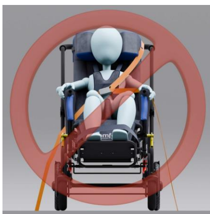
Слика 20ц Неправилно причвршћивање Појас за кукове и грудни кош – поглед спреда
