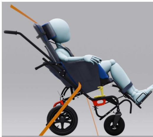
Sl.20b Ispravno pričvršćivanje Pojas za kukove i prsa – bočni pogled
