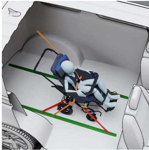
Рис. 18а Правильне закріплення коляски з пацієнтом у транспортному засобі
