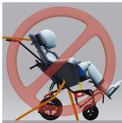
Рис. 20d Неправильне закріплення тазо-плечового ременя – вид збоку
