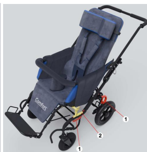
Abb. 17 Stellen, an denen die Trolley-Gurte im Fahrzeug befestigt sind (1)
