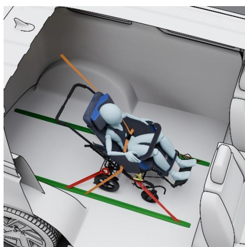
Abb. 18a Richtiges Befestigen Ein Spezial-Rehawagen mit einem Patienten in einem Fahrzeug
